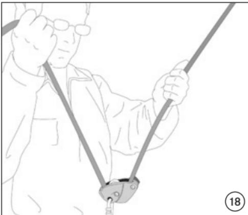
**EDDY - SICHERUNGSGERÄT****SICHERUNGSGERÄT ZUR SICHERUNG DES VORSTEIGERS; ZUM SICHERN MIT SEILUMLENKUNG (TOPROPEN); ZUM ABLASSEN UND ABSEILEN EINER PERSON BEIM KLETTERN**
